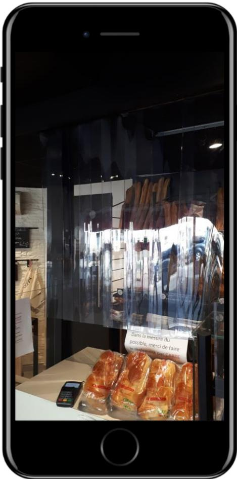
Bandes de PVC transparentes suspendues depuis le plafond dans une boulangerie pour la séparation du poste d'encaissement (utilisation pour des sorties de chambres froides en général. Disponibles en rouleaux de 50 mètres).
